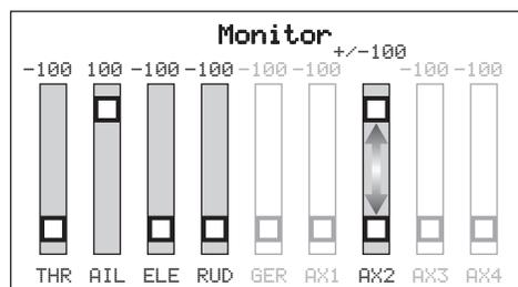
Cet exemple de moniteur de canal montre les positions des manches pour l'attribution d'un commutateur, la sélection du commutateur sur Aux2 et une course +/- 100 % sur le commutateur.
