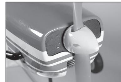
→ Die Verkleidung rund um den Motor herum zurechtschneiden und dann leichtes Sperrholz oder eine Schaumstoffplatte verwenden, um ein Ablenkblech zu bauen, das die Luft direkt über den Motor leitet.
