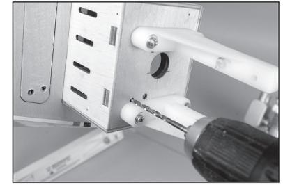
**136.** Das Rohr des Gasgestänges durch die Öffnung im Brandschott schieben. Nach der Installation ragt das Rohr 1,5 mm ( $1/16$  Zoll) aus dem Brandschott heraus.
