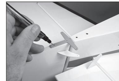
79. Mit einem 1,5 mm Bohreinsatz die zwei Löcher für die Befestigungsschrauben des Spornradarms bohren.
