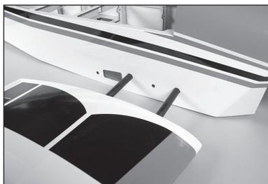
58. Die Tragfläche mit zwei 1/4-20 x 1 Nylon-Flügelschrauben am Rumpf anbringen.
