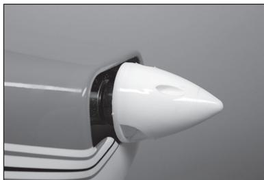
**166.** Sobald die Ausrichtung abgeschlossen ist, die Positionen der Befestigungsschrauben mit einem Filzstift auf der Motorhaube markieren.
