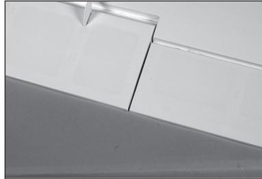
19. Zum Schluss den Spalt zwischen Tragfläche und Klappe an der Tragflächenwurzel prüfen. Die Position von Querruder und Klappe ausrichten, sodass alle drei Spalten gleich sind.
