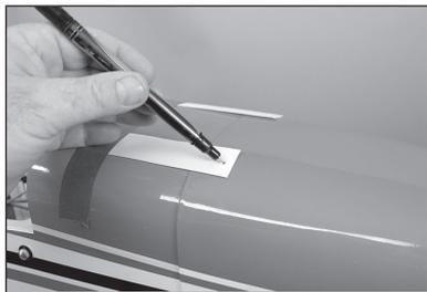
**167.** Die Motorhaube entfernen und mit einem Stiftschraubstock und einem 3 mm (1/8-Zoll)-Bohrer die vier Löcher für die Servobefestigungsschrauben bohren.
