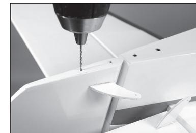
80. Eine M2,5 x 10 Blechschraube mit einem Kreuzschlitzschraubendreher Nr. 2 in jedes Loch schrauben.
