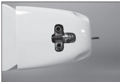
**165.** Den Spinnerkegel an der Spinner-Rückplatte anbringen, um die Ausrichtung der Motorhaube weiter zu überprüfen. Die Motorhaube sitzt etwas höher als der Spinner, was für dieses Flugzeug maßstabsgerecht ist. Es wird einen Abstand von 3 mm (1/8 Zoll) zwischen der Spinner-Rückplatte und der vorderen Motorhaube geben.
