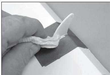
11. Ehe das Epoxid vollständig ausgehärtet ist, das Klebeband um das Steuerhorn entfernen. Dadurch kann das Epoxid um das Steuerhorn fließen und für eine kleine Leiste zwischen Steuerhorn und Oberfläche für ein abgeschlossenes Aussehen und eine sichere Verbindung sorgen. Das Epoxid muss vor dem Fortfahren vollständig ausgehärtet sein.
