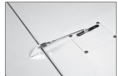
44. Bei mithilfe des Funksystems mittig ausgerichtetem Klappenservo das Gestänge so ausrichten, dass der mittlere Klappenausschlag von 25 mm (1 Zoll) erreicht wird.
