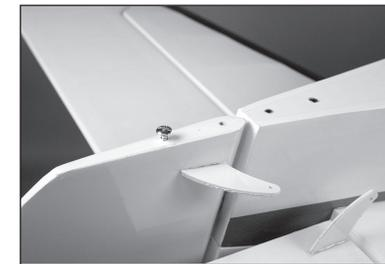
81. Die Schrauben entfernen und 2 bis 3 Tropfen dünnen CA-Klebstoff in jedes Loch geben.
