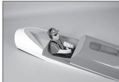
175. Mit Kanzelkleber die Kanzel am Cockpit befestigen. Mit einem Klebeband mit geringer Klebekraft die Kanzel in Position halten, bis der Kleber vollständig ausgehärtet ist.
