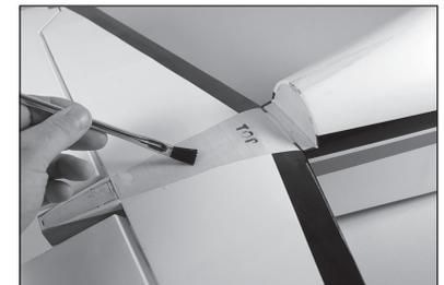
73. Mit einer Epoxidbürste das Epoxid auf die Montagefläche für das Seitenleitwerk auftragen.
