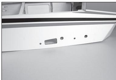
57. Die Tragfläche in Position schieben. Die Kabel von Klappe und Querruder in den Rumpf einführen.
