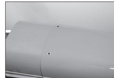
**170.** Den Propeller und die Spinner-Rückplatte an der Motorwelle sichern. Den Spinnerkegel mit den mit dem Spinner mitgelieferten Schrauben anbringen. Bei Bedarf die Öffnungen um den Propeller herum trimmen, da der Propeller bei der Montage nicht mit dem Spinnerkegel in Berührung kommen darf.
