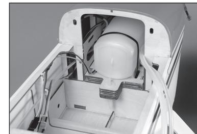
**160.** Einen Kraftstoffeinfüllstutzen an der Seite des Rumpfes einbauen und die Kraftstoffeinfüllleitung verlegen.
