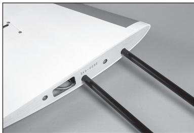
56. Mit einem Hobbymesser und einer 11er-Klinge die Abdeckung für die beiden Flügelschrauben und die Öffnung für die Servokabel auf beiden Seiten des Rumpfes entfernen.
