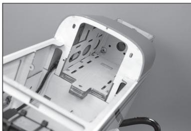
**125.** Die Halterung aus dem Rumpf nehmen und mit einem Seitenschneider die überstehende Schraube von der Oberseite der Halterung entfernen.
