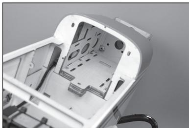
**155.** Die Halterung aus dem Rumpf nehmen und mit einem Seitenschneider die überstehende Schraube von der Oberseite der Halterung entfernen.
