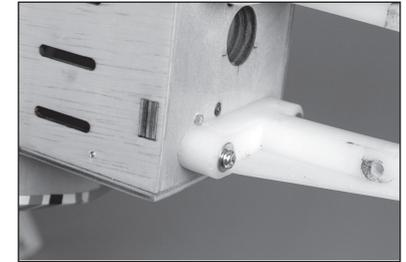
**137.** Das Gestängerohr durch den Rumpf zum Gas-Servo schieben. Darauf achten, dass das Rohr keine extremen Biegungen aufweist, die dazu führen könnten, dass das Gestänge im Rohr stecken bleibt.
