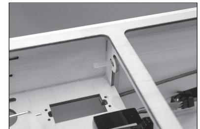
139. Eine M4-Unterlegscheibe auf jede M4 x 30 Schraube schieben, dann eine M4 Kontermutter auf jede Schraube legen. Mit einem Nr. 2 Kreuzschlitzschraubendreher und einem 7 mm Sechskant alle vier Schrauben festziehen und so den Motor an der Motorhalterung sichern.
