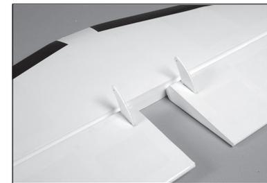
53. Mit einem kleinen Stück Klebeband die Höhenruder für die nächsten Schritte in einer Linie mit dem Stabilisator halten.
