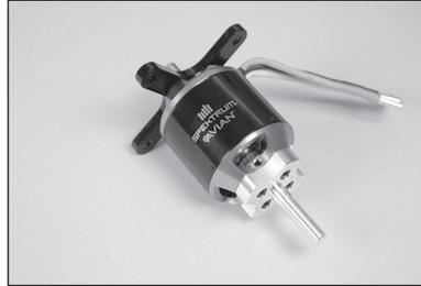
**113.** Den Motor vorübergehend mit zwei M4 x 20 Zylinderkopfschrauben, zwei M4 Unterlegscheiben und zwei M4 Sicherungsmuttern an der Motorkastenplatte befestigen.
