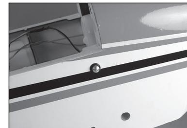
**161.** Der Anschluss für die Entlüftungsleitung ist an der Unterseite des Rumpfes angebracht. Die Entlüftungsleitung an der Verschraubung anschließen.
