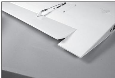
45. Die Steuerung am Sender in die angehobene Klappenstellung bringen. Den Ausschlagprozentatz am Funkgerät einrichten, um die Klappe an der Hinterkante der Tragfläche an der Wurzel auszurichten.
