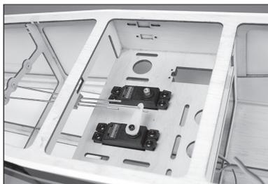
97. Beim Anbringen des Gestänges am Servoarm das Loch im Arm verwenden, das 25 mm (1 Zoll) von der Mitte des Servohorns entfernt liegt. Dieses Loch muss mit einem Feilkloben und einem 2 mm (5/64 Zoll) Bohrer vergrößert werden.
