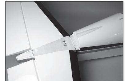
72. 25 ml (3/4 oz) 30-minütiges Epoxid mischen. Mit einer Epoxidbürste das Epoxid auf das freigelegte Holz auf der Oberseite des Stabilisators auftragen.
