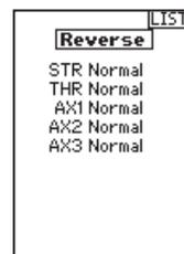
**ACHTUNG:** Binden Sie immer den Sender und Empfänger nach der Umkehr des Gaskanals erneut. Wird dies unterlassen, so kann dies dazu führen, dass sich Gas auf Vollgas bewegt, wenn sich Failsafe aktiviert.
