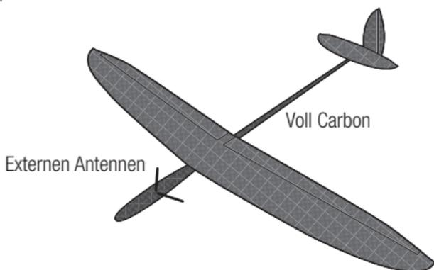
Führen Sie eine Feeder Antenne durch das Loch nach außen, bis die gesamten 31mm des aktiven Teils der Antenne und ca. 2 mm der Verlängerung außen sichtbar sind. Kleben Sie die Antenne mit einem Tropfen Sekundenkleber fest.
