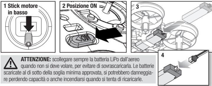
**ATTENZIONE:** scollegare sempre la batteria LiPo dall'aereo quando non si deve volare, per evitare di sovrascaricarla. Le batterie scaricate al di sotto della soglia minima approvata, si potrebbero danneggiare perdendo capacità o anche incendiarsi quando si tenta di ricaricarle.
