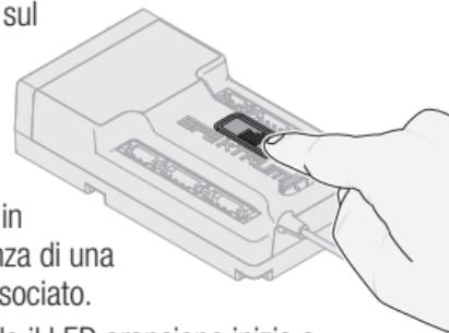
3. Rilasciare il pulsante di binding quando il LED arancione inizia a lampeggiare in modo continuo, a indicare che il ricevitore è in modalità di binding.
