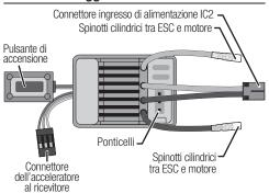
AVVISO: scollegare sempre la batteria dall'ESC quando si ripone il modello dopo l'uso. Se si lascia la batteria collegata, l'ESC continuerà ad assorbire corrente anche se l'interruttore di alimentazione è su OFF, con conseguenti rischi di danni alla batteria dovuti a scaricamento eccessivo.
