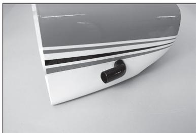
**169.** Fissare la cappottatura con quattro viti a testa tonda M3 x 10 e quattro rondelle M3.
