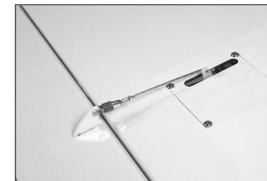
44. Con il servo del flap centrato tramite il radiocomando, regolare il leveraggio per impostare la corsa media del flap a 25 mm.
