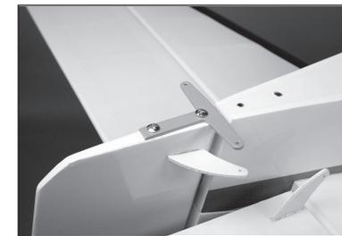
83. Posizionare le rondelle di bloccaggio M3 sulla viti di montaggio M3 x 12 della staffa del ruotino di coda.
