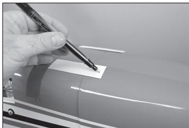
**167.** Rimuovere la cappottatura e con un minitrapano con punta da 3 mm praticare i fori per le viti di montaggio.
