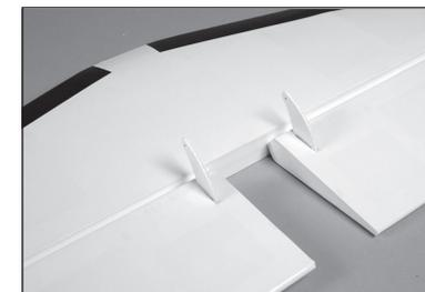
53. Utilizzare un piccolo pezzo di nastro adesivo a bassa aderenza per mantenere gli equilibratori allineati allo stabilizzatore per le fasi successive.
