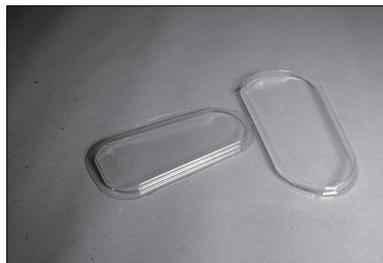
173. Utilizzare colla per capottine per fissare il finestrino al cockpit. Utilizzare nastro a bassa aderenza per tenere in posizione il finestrino fino a quando la colla non si asciuga.
