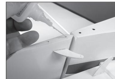
82. Una volta asciugata del tutto la colla cianoacrilica, fissare il braccio del ruotino al fondo del timone con due viti e un cacciavite a croce #2.
