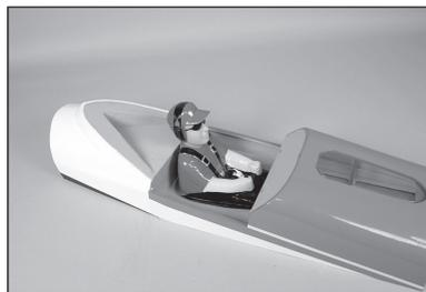
175. Utilizzare colla per capottine per fissare la capottina all'abitacolo. Utilizzare un nastro a bassa adesione per tenere in posizione la capottina fino all'asciugatura completa dell'adesivo.
