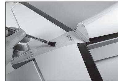
73. Con un pennello per colla epossidica, applicare la colla sulla superficie di montaggio della deriva.
