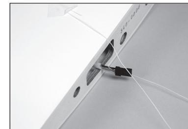
34. Fissare il coperchio del servo dell'alettone con un cacciavite a croce #1 e quattro viti autofilettanti M2,5 x 10.
