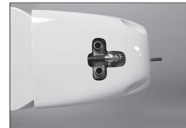
**165.** Montare il cono dell'ogiva sulla piastra posteriore dell'ogiva per continuare a verificare l'allineamento della cappottatura. La cappottatura sarà leggermente più alta dell'ogiva, che è in scala per questo aereo. Ci sarà uno spazio di 3 mm tra la piastra posteriore dell'ogiva e la parte anteriore della cappottatura.
