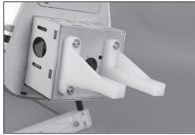
**131.** Sistemare il motore tra i supporti motore. Regolare il motore in modo che la superficie del disco di trasmissione si trovi 141 mm davanti al tagliafiamma.
