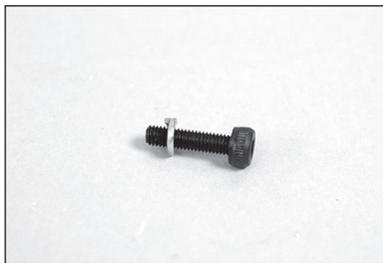
84. Fissare la staffa del ruotino di coda al fondo della fusoliera con le due viti a esagono incassato M3 x 12. Serrare le viti con una chiave a brugola da 2,5 mm.
