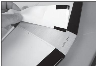
65. Con un taglierino con lama #11, tagliare con attenzione la copertura sul bordo d'attacco dove lo stabilizzatore entra in contatto con la fusoliera.
