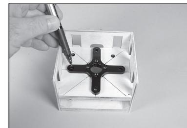
**111.** Rimuovere il supporto e praticare per le viti di montaggio utilizzando un trapano con punta da 5,5 mm.
