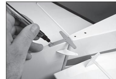
79. Utilizzare un trapano con punta da 1,5 mm per praticare i due fori per le viti di montaggio del ruotino.
