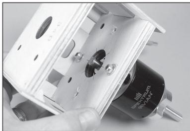
**114.** Se si utilizza il motore Spektrum Avian consigliato, posizionare la piastra della scatola motore completamente in avanti. Il supporto è adattabile a diversi motori.
