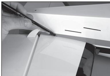
64. Con un taglierino con lama #11, tagliare con attenzione il rivestimento di 3 mm all'interno della linea tracciata sul fondo dello stabilizzatore per rimuovere il rivestimento dal centro dello stabilizzatore. Prestare attenzione a non tagliare il legno sottostante per non indebolire lo stabilizzatore.
