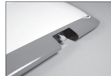
49. La copertura della luce di atterraggio non è simmetrica e si conformerà al profilo dell'ala. Assicurarsi che sia orientata nella direzione corretta quando la si incolla.
