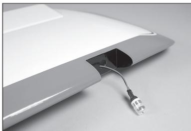
48. Utilizzare una piccola quantità di adesivo al silicone per incollare la luce di atterraggio in posizione sull'ala.
