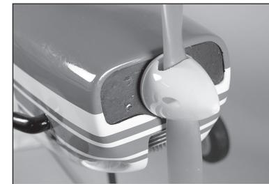
→ Rifilare la cappottatura intorno al motore, quindi utilizzare del compensato leggero o cartone espanso per creare un deflettore che diriga l'aria direttamente sul motore.
