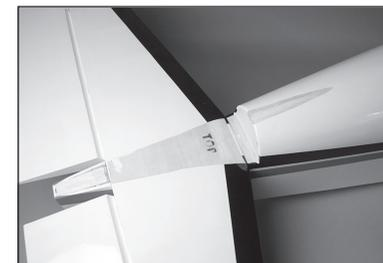
72. Mescolare 25 ml di colla epossidica "30 minuti". Con un pennello per colla epossidica, applicare la colla sul legno esposto della parte superiore dello stabilizzatore.
