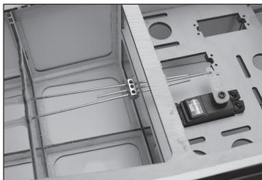
95. Posizionare il connettore in modo che sia centrato tra le aste dell'equilibratore e del servo. Applicare una goccia di frenafili sulle ciascuna vite mentre vengono serrate in posizione. Viti di fermo vengono utilizzate per fissare sia l'asta dell'elevatore sia quella del servo.
