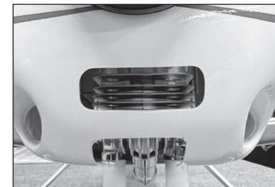
→ Se l'ingresso aria aggiuntivo non risolve i problemi di surriscaldamento, provare a bloccare le aperture attorno all'ogiva con del compensato leggero o cartone espanso.
