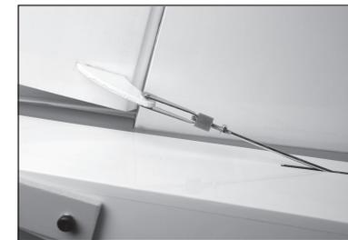
93. Far scorrere il connettore dell'asta dell'equilibratore sull'asta dal servo. L'asta si troverà nel foro centrale del connettore.
