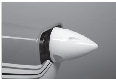
**166.** Ottenuto l'allineamento, contrassegnare con un pennarello a feltro le posizioni delle viti di montaggio sulla cappottatura.
