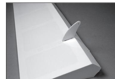
6. Utilizzare nastro adesivo a bassa aderenza attorno alle squadrette controllo per evitare che la colla possa fissarsi sulla superficie di controllo.
