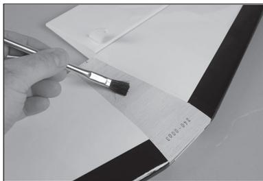
68. Con un pennello per colla epossidica, applicare la colla sulla superficie di montaggio dello stabilizzatore. Riposizionare lo stabilizzatore sulla fusoliera e controllarne l'allineamento. Con un panno di carta e una piccola quantità di alcool isopropilico, rimuovere la colla epossidica in eccesso dalla fusoliera e dallo stabilizzatore prima che la colla si asciughi. Prima di procedere, lasciare che la colla si asciughi del tutto.
