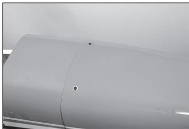
**170.** Fissare l'elica e la piastra posteriore dell'ogiva all'albero motore. Fissare il cono dell'ogiva usando le viti fornite con l'ogiva. Rifilare le aperture attorno all'elica, se necessario a evitare che l'elica possa entrare in contatto con il cono dell'ogiva una volta installata.
