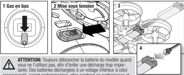
**ATTENTION:** Toujours débrancher la batterie du modèle quand vous ne l'utilisez pas, afin d'éviter une décharge trop importante. Des batteries déchargées à un voltage inférieur à celui recommandé, seront endommagées, elles perdront en performance et pourront entraîner un risque d'incendie durant la charge.
