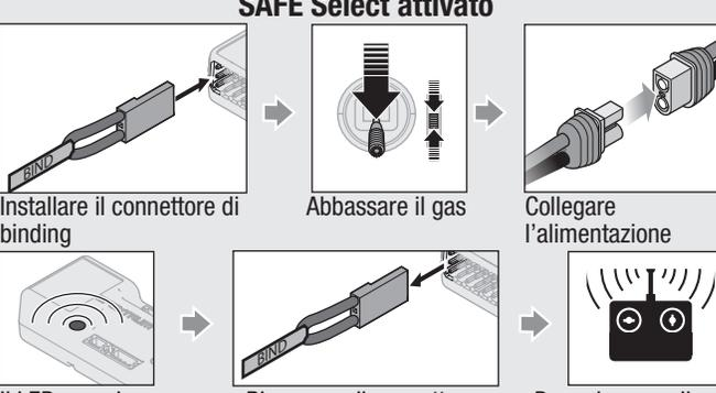
Installare il connettore di binding → Abbassare il gas → Collegare l'alimentazione
