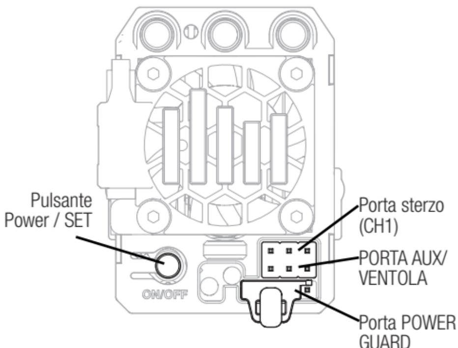
**AVVISO:** scollegare sempre la batteria dal 2-in-1 dopo aver finito e prima di riporre il modello. Se si spegne il veicolo con il pulsante di accensione ma si lascia la batteria collegata, l'ESC continuerà ad assorbire corrente, con possibili danni alla batteria dovuti a scarica eccessiva.
