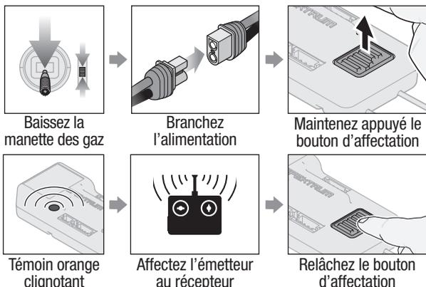
**SAFE SELECT ACTIVÉ** : Les surfaces de commande effectuent deux cycles d'avant en arrière avec une légère pause en position neutre chaque fois que le récepteur est allumé.
