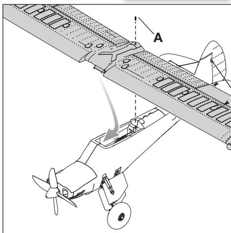
**IMPORTANTE:** individuare la coppia di montanti alari, sono specifici per destra e sinistra. La linguetta di montaggio del montante è angolata verso l'alto con il più lungo dei due puntoni orientato verso il bordo d'attacco alare.
